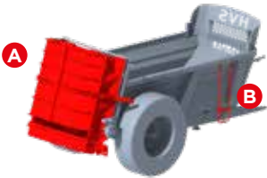
(A) Streuhaube mit doppelter Heckklappe (B) Aufstiegsleiter für Sicht in das Kasteninnere
